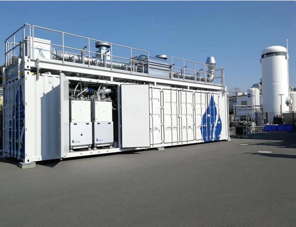
Sunfire SOEC-Elektrolyseur im Stahlwerk Salzgitter, Chemie.de
